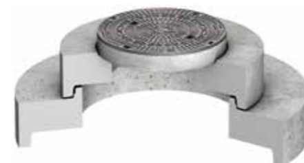
Gornji dio izrađen od armiranog betona s prijelaznom pločom i poklopcem okna od lijevanog željeza, razred opterećenja D400 prema HRN EN 124
