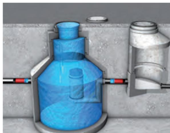
Ispitivanje vodo nepropusnosti treba provesti prije zatrpanja separatora (kako bi se po potrebi mogli otkloniti nedostaci) u skladu s HRN EN 1508.
