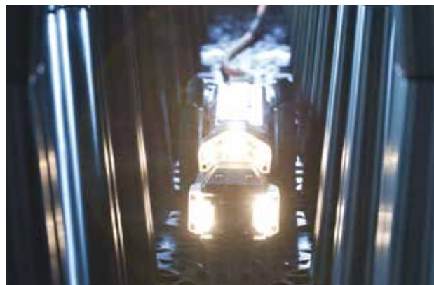
Samohodna kanalizacijska kamera
