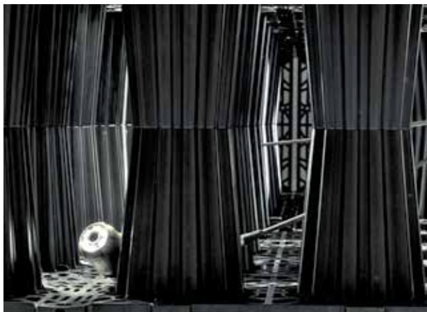
Kamera s potisnim kabelom (tzv. crv)
