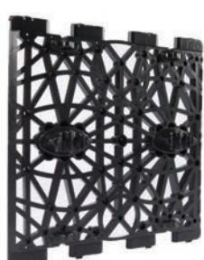
Polipropilenske čone stijenke montiraju se na rubu sustava da bi se sprječio prodror zasipnog materijala u spremnik. Imaju posebno dizajniran sustav za jednostavnu montažu u za to pripremljene utore na rubovima polublokova.
