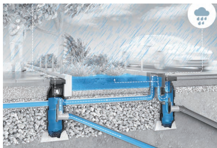
Slika 3: Grad spužva je napunjen – izborni preliv akumulirane vode u kanal
