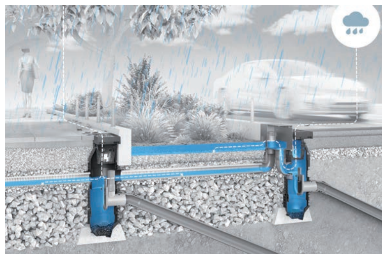
Slika 2: Kiša počinje – Grad spužva se počinje puniti
