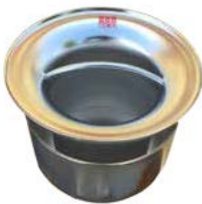
Prikaz konačnog proizvoda nakon postupka elektropoliranja - visoki reflektirajući sjaj.
