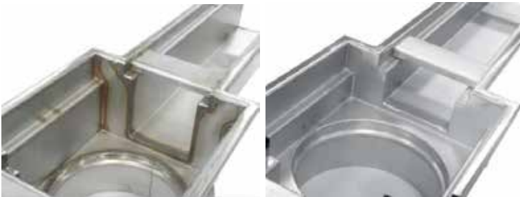
Prikaz proizvoda prije i nakon postupka pasivizacije - mat sjaj.
