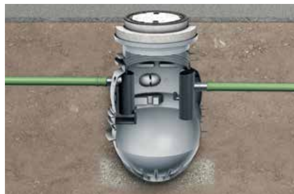
LIPUMAX P: Separatori masnoće za ugradnju u zemlju izvan zgrada. Razred opterećenja do D400 (kamion).
