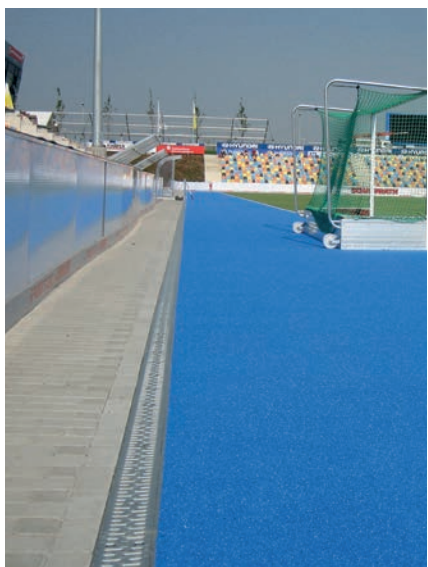
ACO SPORT® 6000 je kanal svjetlog otvora 100 mm, sa profilom za uklještenje umjetne trave, izrađen od polimerbetona. Pokrovna rešetka sadrži Quicklock zaključavanje za kanal ili sabirnik.
