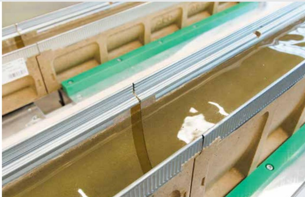
Ispitivanje vodonepropusnosti spoja kanala
