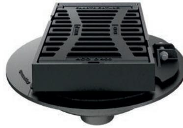
ACO HSD-2 mosni slivnik za mostove AB konstrukcije, dimenzija 300x480 mm, iz lijevanog željeza, razreda opterećenja D400 prema HRN EN 124-2:2015, prema smjernicama Was 1
