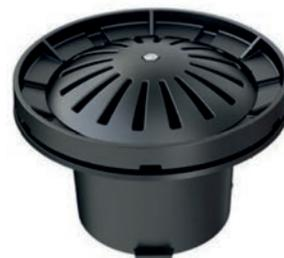
ACO HSD-2 mosni slivnik za željezničke mostove s tucaničkim zastorom, promjera 585 mm, s kuglastom procijednom rešetkom, iz lijevanog željeza, sukladno DB Netz, Deutsche Bahn Group, M-ENT 804.9020
