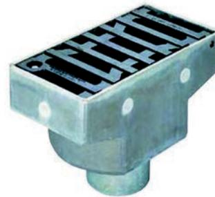
ACO HSD-2 mosni slivnik za čelične mostove dimenzija 260x500 mm, tijelo iz vruće cinčanog čelika, rešetka iz lijevanog željeza, razreda opterećenja D400 prema HRN EN 124-2:2015, prema smjernicama Was 1
