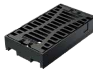
Multitop® slivna rešetka 300x500 mm za razrede opterećenja C250 / D400
