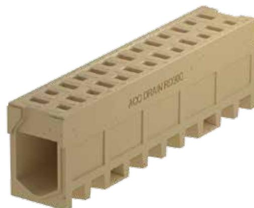
**Monoblock RD300 V revizorni element** monolitne izvedbe iz polimerbetona u natur boji, s rešetkom i zaštitnim rubom iz ljevanog željeza sa predizvedenim vertikalnim izljevom DN300 i bočnim otvorom za kutni, T ili križni spoj kanala. Razred opterećenja F900 prema HRN EN 1433.
