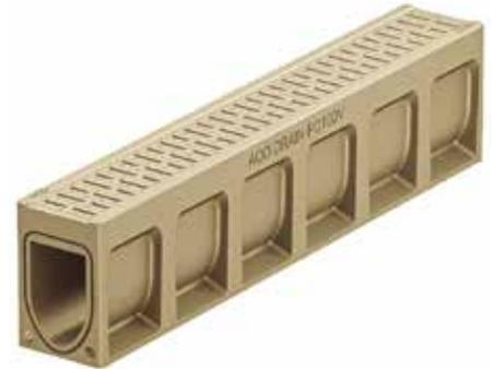
**Monoblock PD100 V revizorni element** monolitne izvedbe iz polimerbetona u natur ili antracit crnoj boji, s rešetkom i zaštitnim rubom iz lijevanog željeza sa vertikalnim izljevom DN100 i predizvedenim bočnim otvorom za kutni, T ili križni spoj kanala. Razred opterećenja D400 prema HRN EN 1433.
